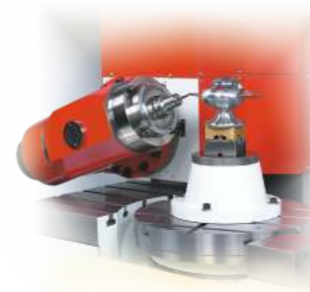
Поворотный стол (ось C) и поворотная шпиндельная головка (ось B) станка SU-85
