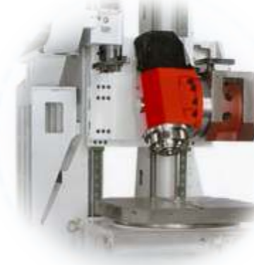
Поворотный стол (ось B) и поворотная шпиндельная головка (ось C) станка VH-119U
